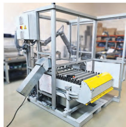
Mobile Automatisierungseinheit von TAT für die Maschinenbeschickung einer CNC-Maschine.
