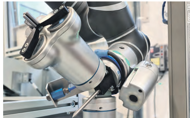
Zentrale Elemente der Gesamtlösung: TM12 Roboter und Doppelzahnriemenförderer inkl. Werkstückträger
