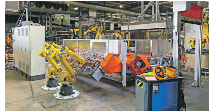
Ein kleiner Ausschnitt während der Integration – servicierte Roboter und Drehtisch mit neuen Vorrichtungen.
